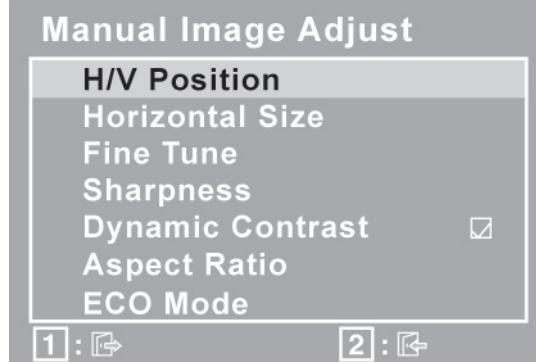
**H./V. Position (Horizontalni/Vertikalni položaj)** pomiče sliku na ekranu udesno ili ulijevo ili prema gore ili prema dolje.
