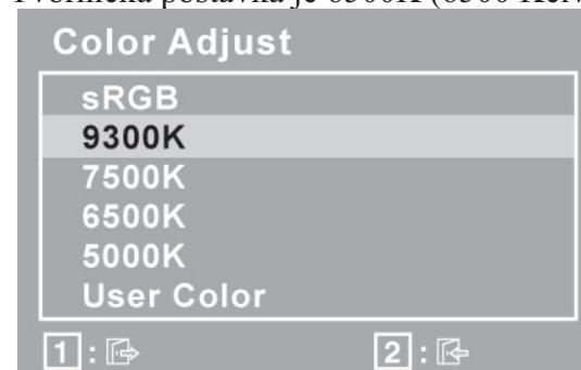
**sRGB**-Ovo će brzo postati industrijski standard za upravljanje bojama, s podrškom koja će biti uključena u veći broj novijih programa. Omogućivanjem ove postavke omogućit će se puno točniji način prikazivanja boja na način na koji se one čine izvorno zamišljenima. Omogućivanjem postavke sRGB će dovesti do toga da podešavanja kontrasta ili svjetline bude onemogućena.
