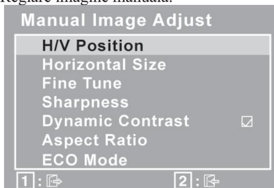
**H./V. Position (Horizontal/Vertical Position) (Poziție H./V. (Poziție Orizontală/Verticală))** mișcă imaginea ecranului în stânga sau dreapta și în sus sau în jos.
