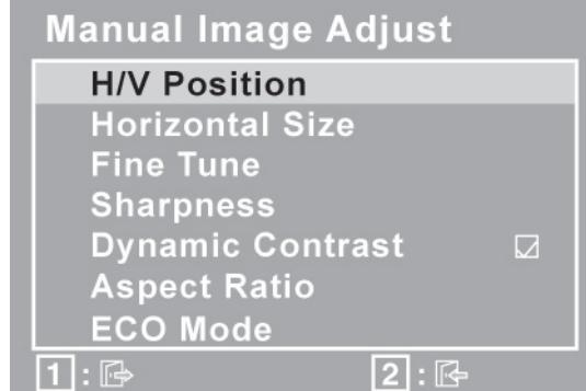
**H./V. Position (Horizontálna/Vertikálna poloha)** posunie obraz na obrazovke doľava alebo doprava, hore alebo dolu.
