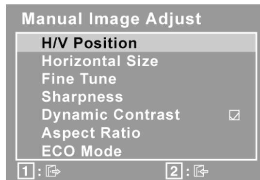
**H./V. Position ( 水平 / 垂直位置 )** 將螢幕影像左右移動或上下移動。
