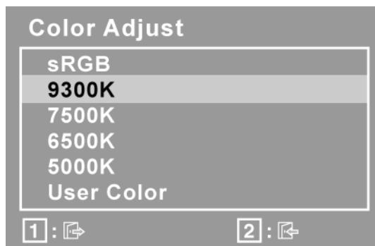
**sRGB** - 是一種顏色管理的工業標準，它支援很多最新的應用程式。啓用此設定，LCD 可以更精確地顯示原始色彩。啓用 sRGB 設定後將關閉 Contrast ( 對比度 ) 和 Brightness ( 亮度 ) 調整。
