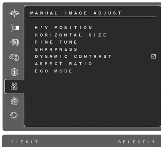
**H./V. Position (Posição Horizontal/Vertical)** movimentam a imagem na tela para a esquerda ou para a direita, para cima ou para baixo.
