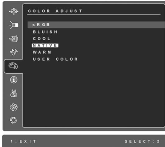
**sRGB**-O sRGB está tornando-se rapidamente o padrão de gerenciamento de cores do setor, sendo inclusive suportado pela maioria dos aplicativos mais recentes. A ativação dessa configuração permite que o monitor LCD reproduza as cores de forma mais precisa, chegando muito próximo das cores projetadas. A ativação da configuração sRGB desativa os ajustes de contraste e brilho.
