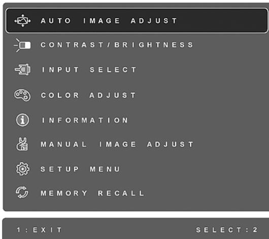
**NOTA:** Todos os menus OSD e as telas de ajuste desaparecem automaticamente após 15 segundos. Isto é ajustável configurando-se o tempo-limite do OSD no menu de configuração.
