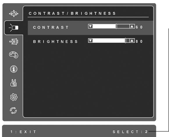
Строка в нижней части экрана предлагает дальнейшие действия: выход из меню или выбор регулировки яркости.
