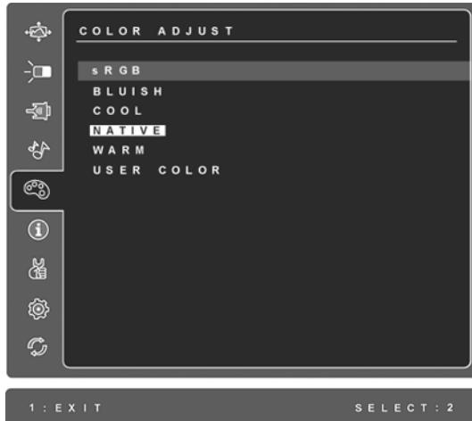
**sRGB-RGB** быстро становится производственным стандартом управления цветом, который поддерживает большинство современных приложений. Эта настройка позволяет более точно отображать цвета на ЖК-дисплее. Включение настройки sRGB делает регулировку контрастности и яркости недоступной.
