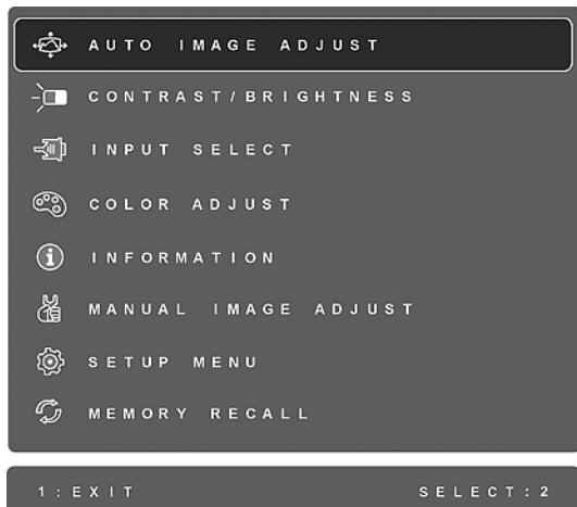
**ПРИМЕЧАНИЕ:** Все меню OSD и экраны регулировки автоматически исчезают с экрана приблизительно через 15 секунд. Этот период времени можно изменять с помощью регулировки лимита времени экранного меню в меню настройки.
