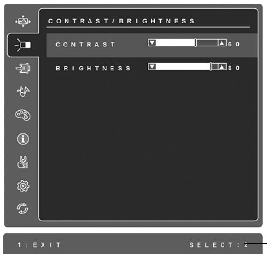
画面下の線はボタン 1 と 2 の現在の機能を示します： Brightness ( 輝度 ) コントロールを Exit ( 終了 ) または選択します。
