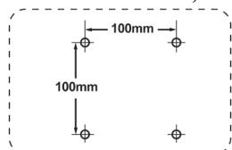
**Krok 7.** LCD displej namontujte na stenu, a to podľa pokynov pre montážnu súpravu pre osadenie na stenu.
