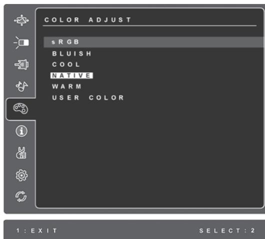
**sRGB-sRGB** se rychle stává standardem správy barev a řada nejnovějších aplikací tuto funkci podporuje. Povolením tohoto nastavení může monitor LCD přesněji reprodukovat barvy v jejich původní podobě. Jestliže nastavení sRGB povolíte, nebudou k dispozici nastavení Contrast (Kontrast) a Brightness (Jas).
