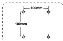
**Krok 5.** LCD displej namontujte na stenu, a to podľa pokynov pre montážnu súpravu pre osadenie na stenu.
