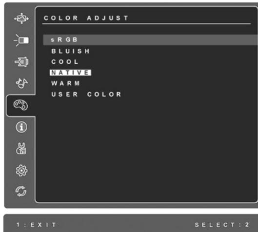
**sRGB**-Ovo će brzo postati industrijski standard za upravljanje bojama, s podrškom koja će biti uključena u veći broj novijih programa. Omogućivanjem ove postavke omogućit će se puno točniji način prikazivanja boja na način na koji se one čine izvorno zamišljenima. Omogućivanjem postavke sRGB će dovesti do toga da podešavanja kontrasta ili svjetline bude onemogućena.
