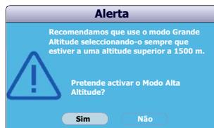
Se utilizar o projector em condições ambientais extremas que não as acima mencionadas, este poderá apresentar sintomas de desactivação automática, destinados a proteger o projector contra aquecimento excessivo. Nestas circunstâncias, deve mudar para **Modo Grande Altitude** para resolver esses sintomas. Contudo, tal não significa que este projector pode funcionar em todas as condições ambientais extremas.
