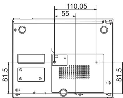
⊙ Parafusos para Montagem no Tecto:
