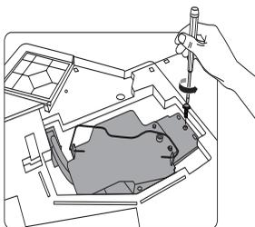
5. Desligue o conector da lâmpada do projector e levante a pega. Utilize a pega para, lentamente, puxar a lâmpada para fora do projector.
