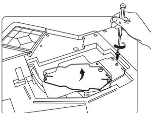
9. Coloque a película de protecção da lâmpada no compartimento da mesma.
