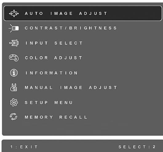
**ПРИМЕЧАНИЕ:** Все меню OSD и экраны регулировки автоматически исчезают с экрана приблизительно через 15 секунд. Этот период времени можно изменять с помощью регулировки лимита времени экранного меню в меню настройки.
