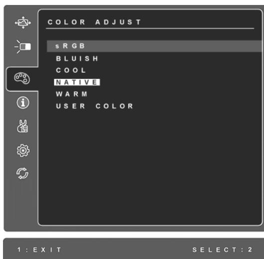
**sRGB-RGB** быстро становится производственным стандартом управления цветом, который поддерживает большинство современных приложений. Эта настройка позволяет более точно отображать цвета на ЖК-дисплее. Включение настройки sRGB делает регулировку контрастности и яркости недоступной.
