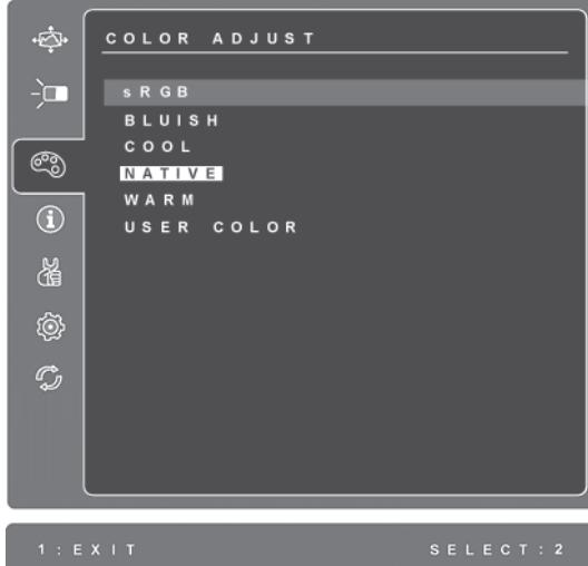
**sRGB**-Ide o rýchlo zaužívaný štandard pre správu farieb s podporou mnohých moderných aplikácií. Jeho aktivácia umožňuje LCD displeju presné zobrazovanie farieb tak, ako vyzerajú v skutočnosti. Aktivácia nastavenia sRGB zablokuje nastavenie kontrastu a jasu.
