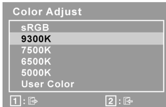
**sRGB** - sRGB wird mehr und mehr zum Industriestandard für die Farbverwaltung. Viele der neuen Anwendungen unterstützen sRGB bereits. Bei Aktivierung dieser Einstellung werden Farben auf der LCD-Anzeige originalgetreuer dargestellt. Die Aktivierung der sRGB-Einstellung führt dazu, dass die Einstellungen für Helligkeit und Kontrast deaktiviert werden.
