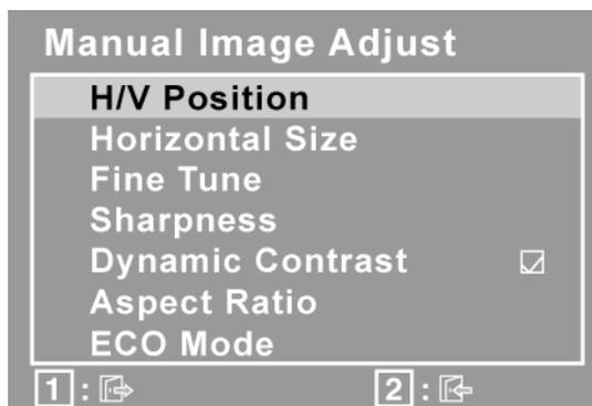
**H./V. Position (Horizontale/Vertikale Position)** verschiebt das Bild nach links oder rechts, nach oben oder nach unten.
