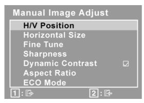
**H./V. Position (Posição Horizontal/Vertical)** movimenta a imagem na tela para a esquerda ou para a direita, para cima ou para baixo.
