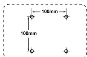
**Шаг 5.** Установить ЖК-монитора на стену в соответствии с инструкциями, прилагаемыми к комплекту для настенного монтажа.
