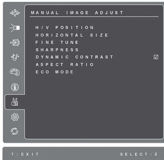
**H./V. Position (Horizontálna/Vertikálna poloha)** posunie obraz na obrazovke doľava alebo doprava, hore alebo dolu.
