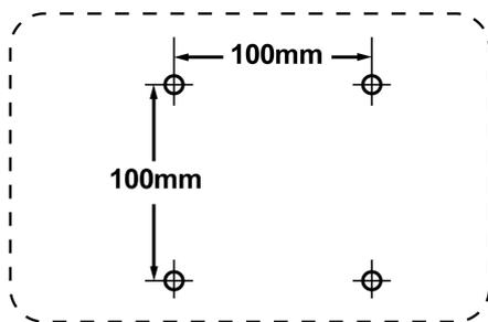
**步骤 5.** 请遵循壁挂安装套件中的提示信息，将 LCD 显示器与墙体相连。
