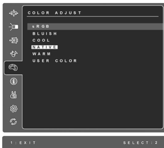
**sRGB-** 是一种颜色管理的工业标准，它支持很多最新的应用程序。启用此设置，LCD 可以更精确地显示原始色彩。启用 sRGB 设置后将关闭 Contrast(对比度) 和 Brightness(亮度) 调整。
