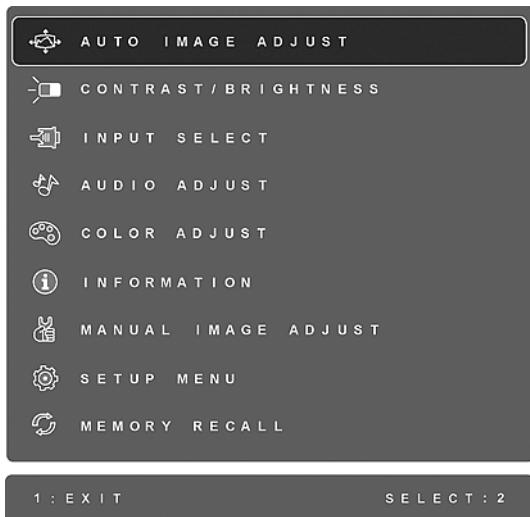
**NOTA:** Todos os menus OSD e as telas de ajuste desaparecem automaticamente após 15 segundos. Isto é ajustável configurando-se o tempo-límite do OSD no menu de configuração.
