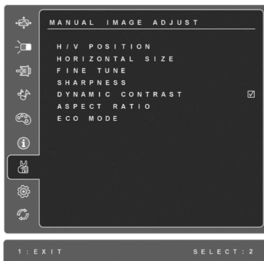
**H./V. Position (Posição Horizontal/Vertical)** movimenta a imagem na tela para a esquerda ou para a direita, para cima ou para baixo.
