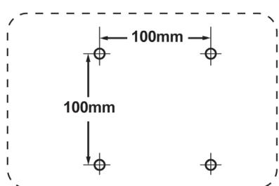
**Krok 5.** LCD displej namontujte na stenu, a to podľa pokynov pre montážnu súpravu pre osadenie na stenu.
