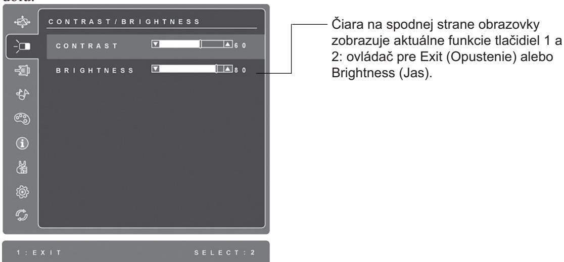
4. Nastavenie ovládača vykonáte stlačením tlačidla so šípkou hore ▲ alebo dolu ▼ .
