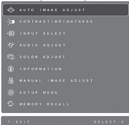
**POZNÁMKA:** Všetky menu obrazovkového displeja a obrazovky pre nastavenie po asi 15 sekundách zmiznú. Toto je možné nastaviť v rámci nastavenia vypnutia obrazovkového displeja v menu pre nastavenie.
