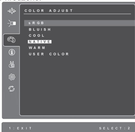
**sRGB**-Ide o rýchlo zaužívaný štandard pre správu farieb s podporou mnohých moderných aplikácií. Jeho aktivácia umožňuje LCD displeju presné zobrazovanie farieb tak, ako vyzerajú v skutočnosti. Aktivácia nastavenia sRGB zablokuje nastavenie kontrastu a jasu.
