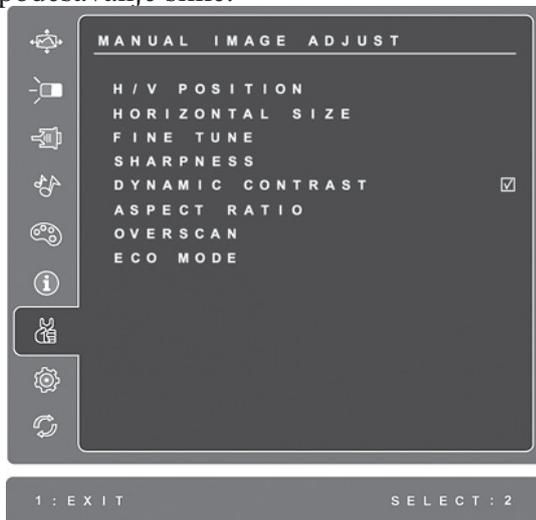
**H./V. Position (Horizontalni/Vertikalni položaj)** pomera sliku na ekranu levo ili desno i gore ili dole.
