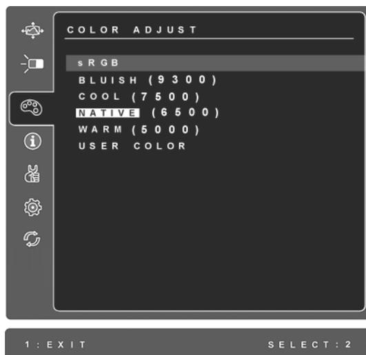
**sRGB**-est en train de devenir rapidement le standard de l'industrie pour la gestion des couleurs, et la plupart des applications récentes sont compatibles avec ce format. L'activation de ce paramètre permet à l'écran LCD d'afficher des couleurs plus fidèles à l'original. L'activation du paramètre sRGB entraîne la désactive les réglages du contraste et de la luminosité.
