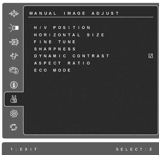
**H./V. Position (Position Horizontale/Verticale)** déplace la position de l'image à gauche ou à droite et en haut ou en bas.
