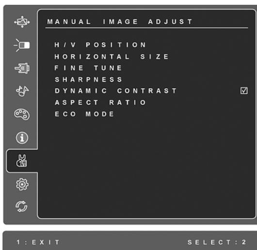
**H./V. Position (Horizontale/Vertikale Position)** verschiebt das Bild nach links oder rechts, nach oben oder nach unten.
