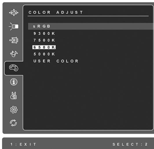
**sRGB** - sRGB wird mehr und mehr zum Industriestandard für die Farbverwaltung. Viele der neuen Anwendungen unterstützen sRGB bereits. Bei Aktivierung dieser Einstellung werden Farben auf der LCD-Anzeige originalgetreuer dargestellt. Die Aktivierung der sRGB-Einstellung führt dazu, dass die Einstellungen für Helligkeit und Kontrast deaktiviert werden.
