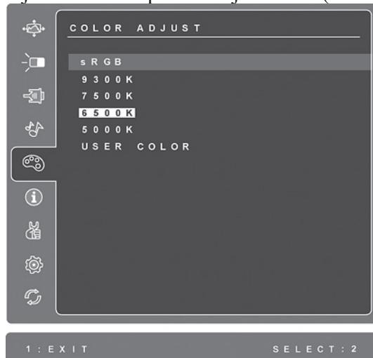
**sRGB**-Ovo će brzo postati industrijski standard za upravljanje bojama, s podrškom koja će biti uključena u veći broj novijih programa. Omogućivanjem ove postavke omogućit će se puno točniji način prikazivanja boja na način na koji se one čine izvorno zamišljenima. Omogućivanjem postavke sRGB će dovesti do toga da podešavanja kontrasta ili svjetline bude onemogućena.
