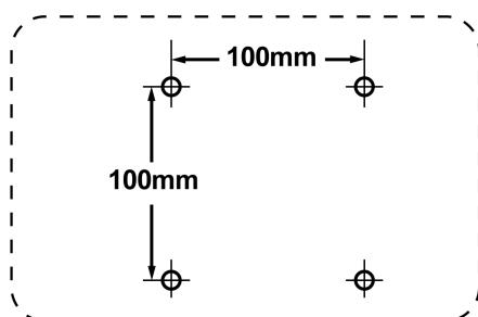
**步骤 5.** 请遵循壁挂安装套件中的指示信息, 将 LCD 显示器与墙体相连。
