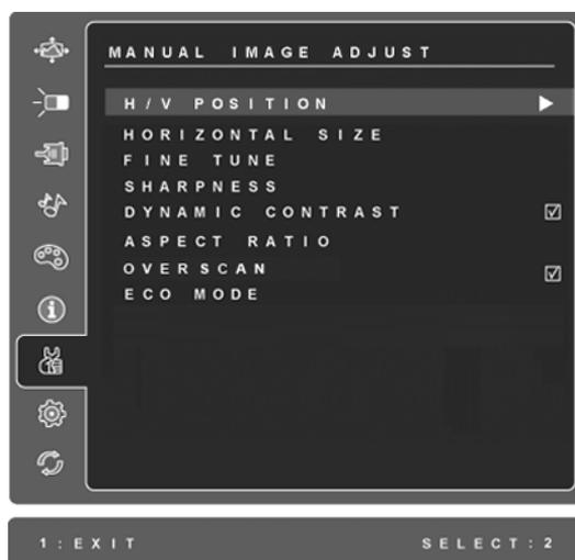
**H./V. Position (Horizontální/vertikální poloha)** posunuje zobrazení na monitoru vlevo, vpravo, nahoru nebo dolů.
