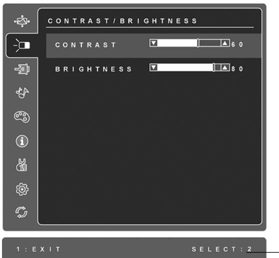
画面下の線はボタン 1 と 2 の現在の機能を示します: コントロールを Exit ( 終了 ) または選択します。
