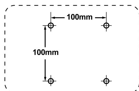
**ステップ 5。** 壁取り付けキットの説明書に従い、液晶ディスプレイを壁に取り付けます。
