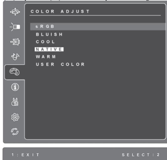
**sRGB**-Ovo ubrzano postaje industrijski standard za upravljanje bojama, uz podršku koja uključena u mnogim najnovijim aplikacijama. Omogućavanje ovog podešavanja dozvoljava LCD ekranu da preciznije prikaže boje na način na koji je to prvobitno nameravano. Omogućavajući sRGB podešavanje doveće do isključivanja podešavanja kontrasta (Contrast) i osvetljenja (Brightness).
