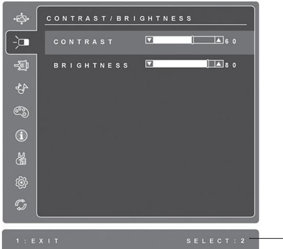
Črta na dnu zaslona prikazuje tekoče funkcije gumbov 1 in 2: Pritisnite "Exit (Izhod)" ali izberite "Brightness control (Nastavitev svetlosti)".
