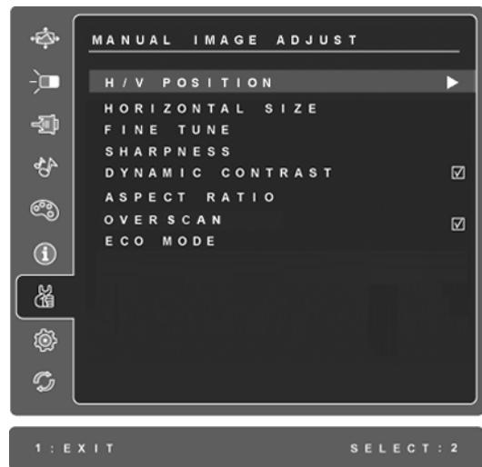
**H./V. Position (水平 / 垂直位置)** 將螢幕影像左右移動或上下移動。
