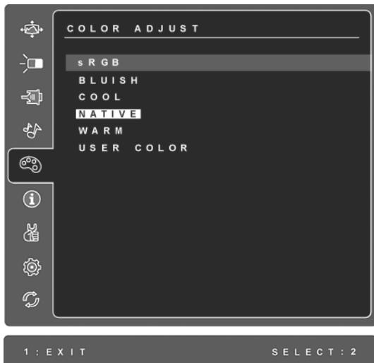
**sRGB** - 是一種顏色管理的工業標準，它支援很多最新的應用程式。啓用此設定，LCD 可以更精確地顯示原始色彩。啓用 sRGB 設定後將關閉 Contrast (對比度) 和 Brightness (亮度) 調整。
