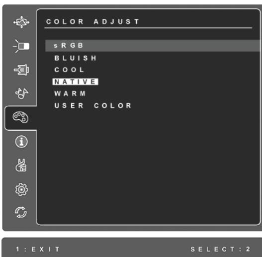
**sRGB**-sRGB se rychle stává standardem správy barev a řada nejnovějších aplikací tuto funkci podporuje. Povolením tohoto nastavení může monitor LCD přesněji reprodukovat barvy v jejich původní podobě. Jestliže nastavení sRGB povolíte, nebudou k dispozici nastavení Contrast (Kontrast) a Brightness (Jas).
